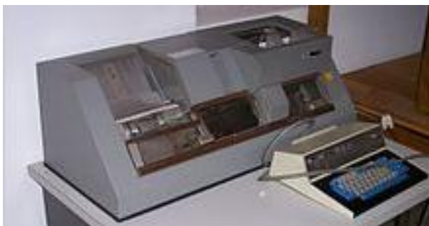
Abbildung 2: Lochkartenstanzer von IBM
