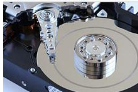
Abbildung 3: Geöffnete Festplatte nach einem Head-Crash. Die Schleifspuren des defekten Schreib-Lese-Kopf sind deutlich zu erkennen.
