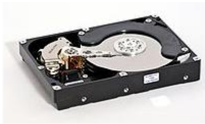
Abbildung 1: Geöffnete Festplatte mit drei Magnetscheiben, Schreib- und Lesekopf und der Mechanik.
